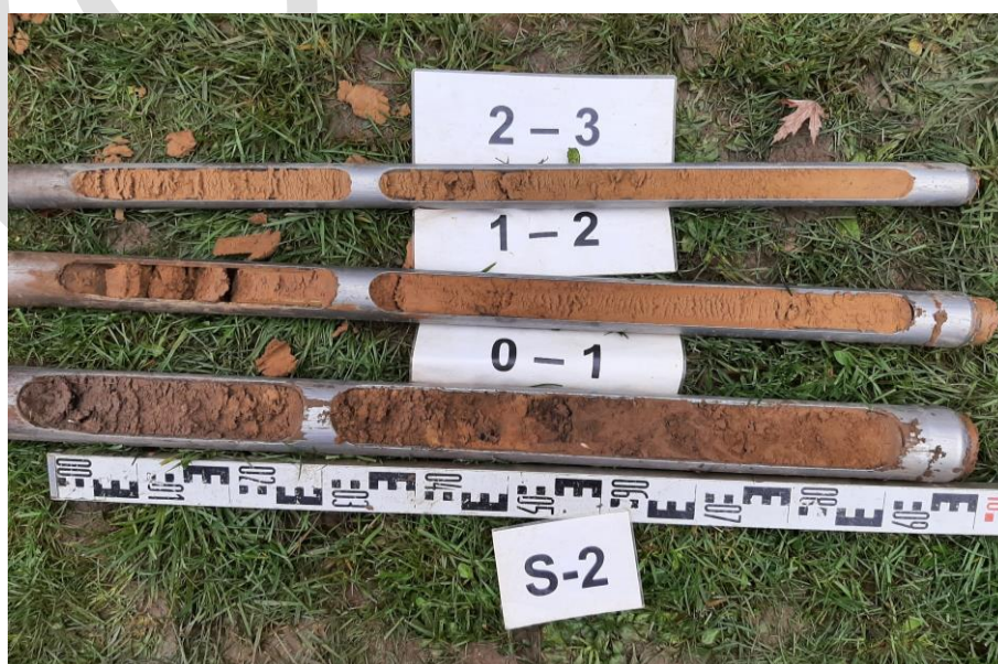
Obr. 4 Zastížené zeminy sondou S-2 v hloubce 0,0 – 3,0 m
