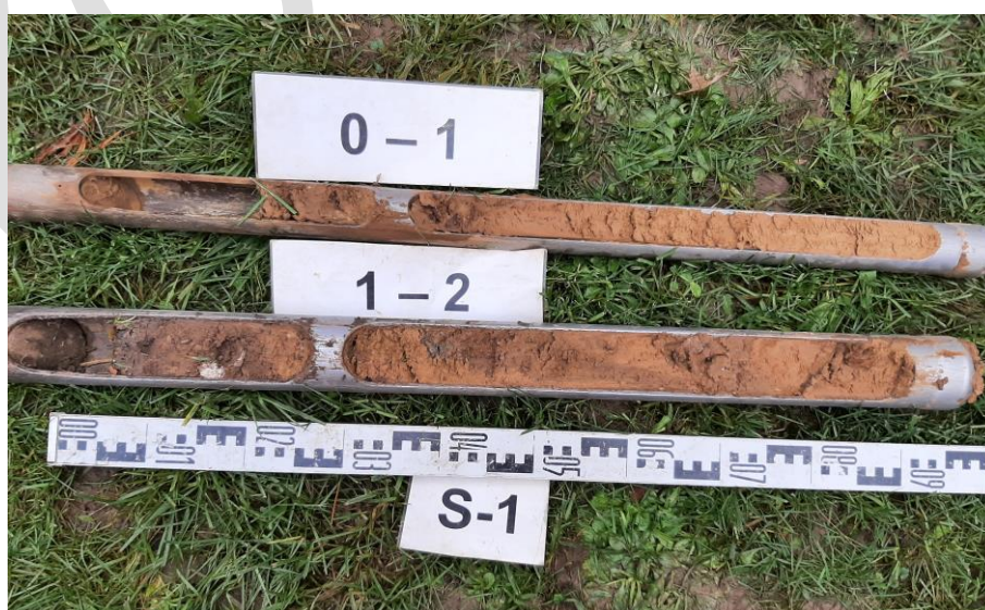
Obr. 2 Zastižené zeminy sondou S-1 v hloubce 0,0 – 2,0 m
